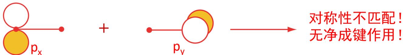
两AOs相对于包含键轴的同一个镜面的反映操作对称性不匹配!
